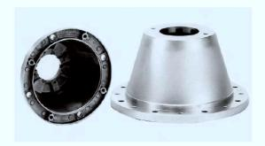
用于 IEC 标准电机和液压泵的连接适用于各种品牌液压泵 两端法兰机加工处理铝制,压铸工艺如型号 PK400, L1=204, B4=160订货标记: PK400/204/160
